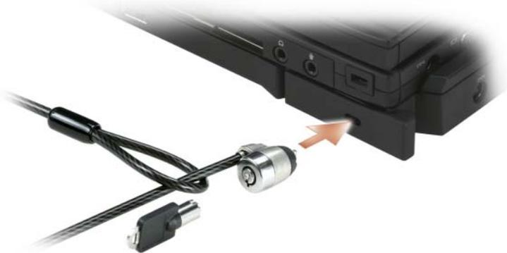
Schließen Sie einen handelsüblichen Diebstahlschutz über den Sicherheitskabeinschub an der Media Base an.
