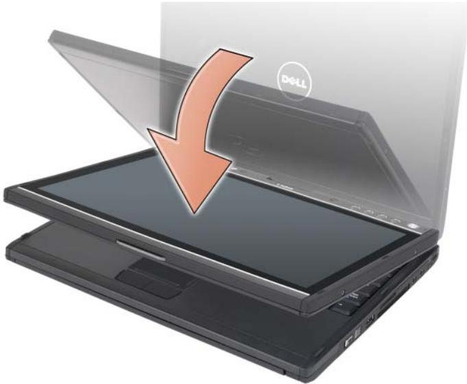
Wenn Sie den Tablet PC vom Notebook- in den Tablet-Modus umschalten, ändert sich die Bildschirmausrichtung des Tablet PCs automatisch und orientiert sich dabei an den Einstellungen, die Sie in der Dell QuickSet-Anwendung oder in der Windows Vista-Stift- und Tabletteinstellungsanwendung definiert haben – gewöhnlich Querformat (Notebook-Modus) und Hochformat (Tablet-Modus). Weitere Informationen zum Anpassen der Tablet PC-Einstellungen finden Sie unter „QuickSet“ auf Seite 75.
